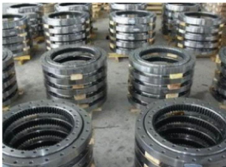
Спецификация поворотный подшипник (поворотное кольцо) для экскаватора
